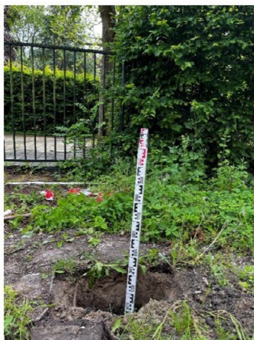
Afbeelding 4: Diepte profielkuil, dieper graven door puin onmogelijk
