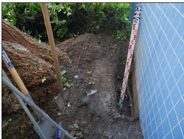
Foto 4 en 5: Links een beeld van de profielsleuf ten opzichte van de stamvoet van de valse acacia. Rechts is een beeld van de beworteling in de profielsleuf. De gele pijl duidt een stabiliteitswortel met een diameter van 15 cm aan.
