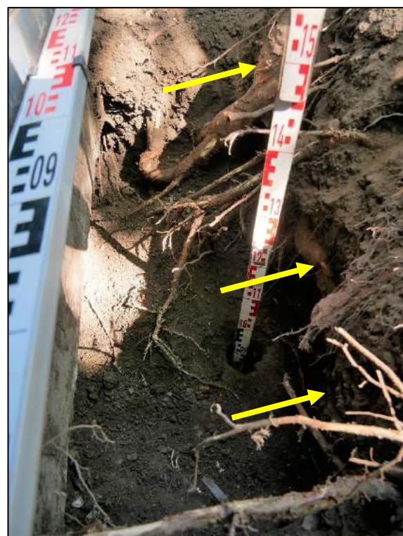
Foto 6 en 7: Links een beeld van de locatie van de profielsleuf ten opzichte van de stamvoet. Rechts een beeld van de profielsleuf met intensieve beworteling. Met gele pijlen zijn individuele parallel aan de gevel lopende stabiliteitswortels aangeduid.
